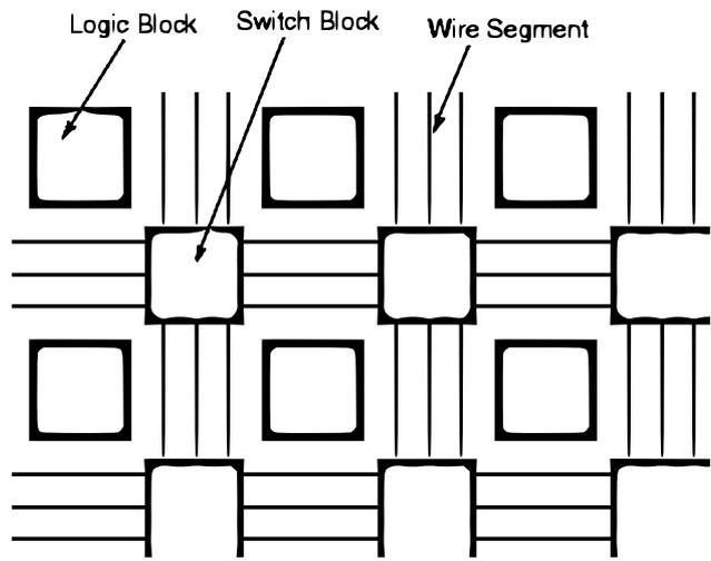
Abbildung 6: Leitungslängen in Kanälen
