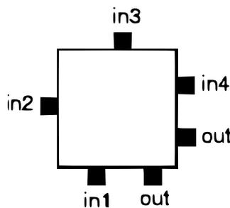
Abbildung 4: Anordnung der Pins eines Logikblocks
