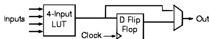
Abbildung 2.2: Aufbau eines Logikblockes
