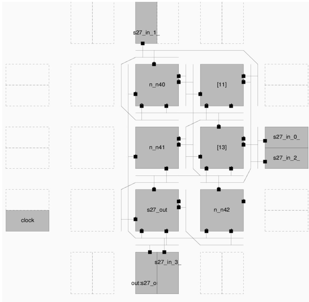
Abbildung 3.2: Platzierte und verdrahtete Beispielschaltung
