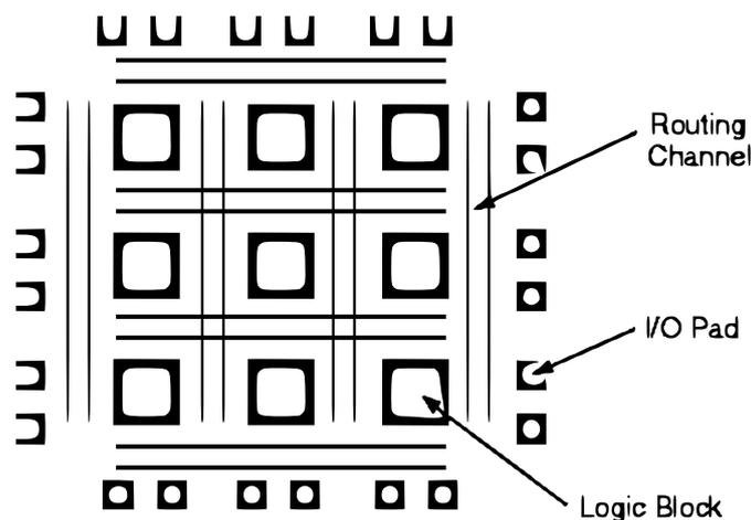
Abbildung 2.1: Struktur des FPGAs
