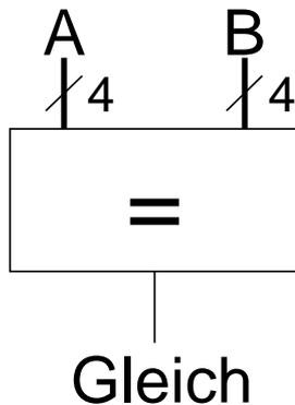
der Ausgang **Gleich** ist 1, wenn A und B gleich sind.
