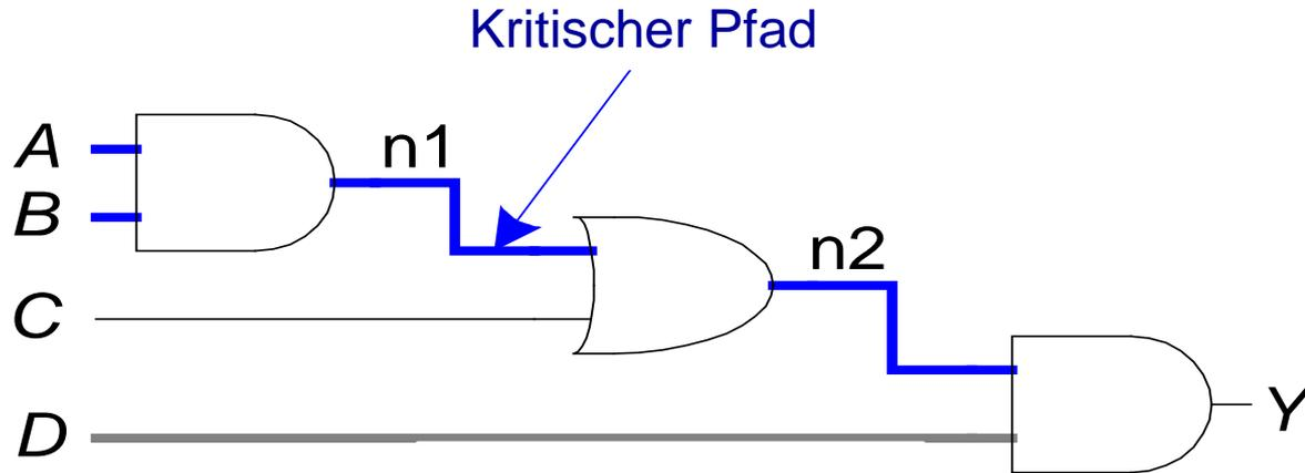
Kritischer (langer) Pfad von Eingang bis zum Ausgang:  $t_{pd} = 2t_{pd\_AND} + t_{pd\_OR}$
