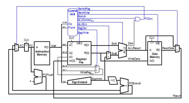
Welche Komponenten werden bei der Ausführung des Befehls add \$t0 \$t1 \$t2 verwendet? Wie sind die Steuersignale belegt?
