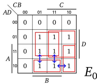
Simulation des Übergangs  $ABC\bar{D} \rightarrow A\bar{B}C\bar{D}$  :
