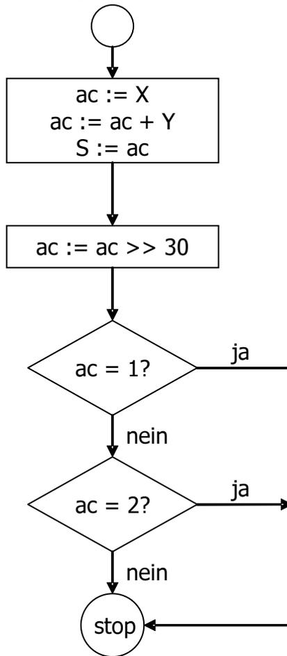
**d)** Schreiben Sie nun das Assembler-Programm. Die Operanden stehen in den Speicherzellen 18 und 19. Die Summe  $S$  soll in der Speicherzelle 20 abgelegt werden. Die Überlaufbedingung soll in dem C-Bit gespeichert werden, danach soll das Programm stoppen.
