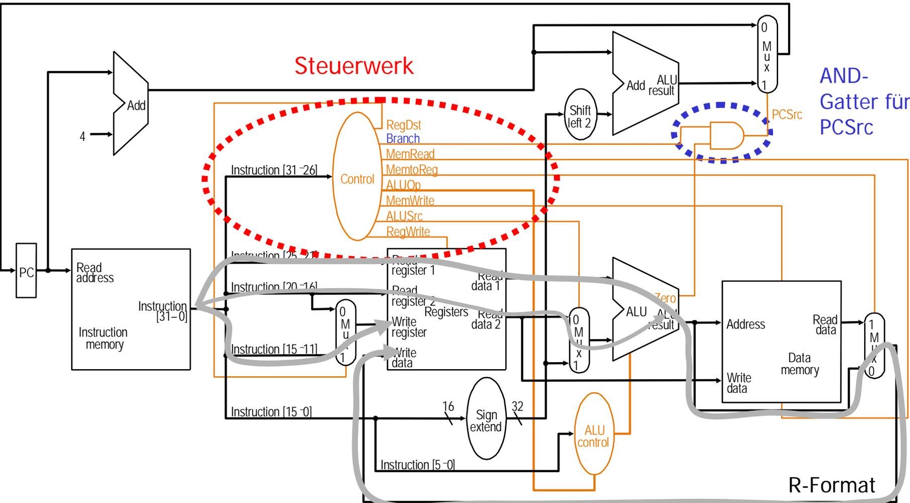
Das Steuerwerk besitzt bei der Eintakt-Implementierung keine Zustandsregister, ist also nur ein Schaltnetz
