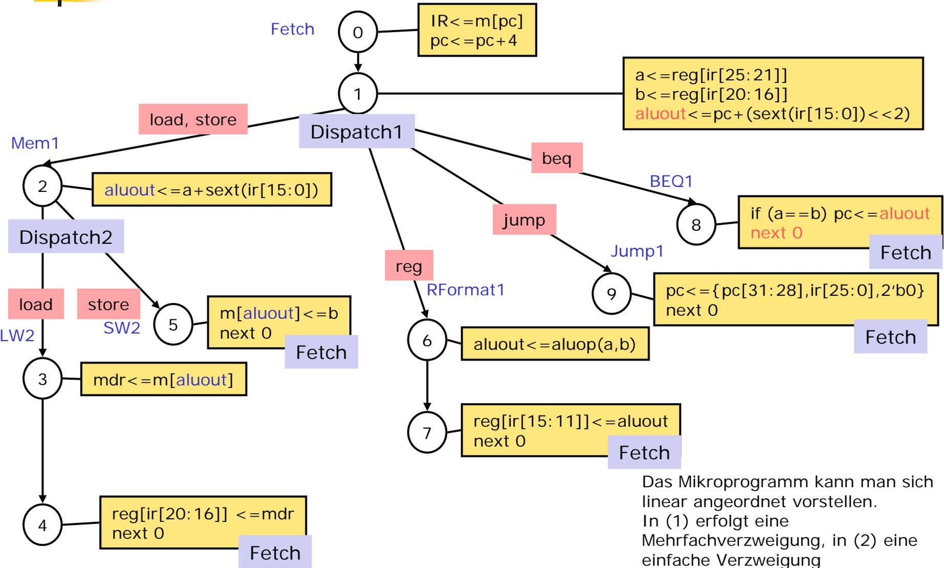
Das Mikroprogramm kann sich linear angeordnet vorstellen. In (1) erfolgt eine Mehrfachverzweigung, in (2) eine einfache Verzweigung
