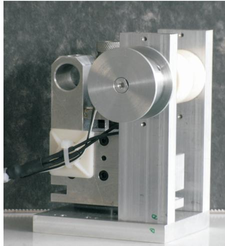
Am Institut für Elektromechanische Konstruktionen (EMK, FB 18) werden Servomotoren mittels Piezoaktoren betrieben. Die dazu notwendige Regelungselektronik umfasst
