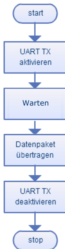
Abbildung 61: Softwareablauf beim Senden von Daten
