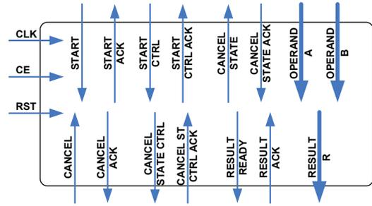
Fig. 3. Modlib Module Interface
